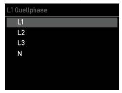
**Optionaler Schritt:** Navigiere mit der Aufund Ab-Taste zu der Phase, welche du neu zuornen möchtest, um deine falsch angeschlossene Phase zu korrigieren.
