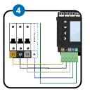
Der go-e Controller kann auch mit einem anderen Verbraucher, beispielsweise dem E-Herd, mit an eine Sicherung angeschlossen werden. Wenn das nicht möglich ist, musst du eine neue Sicherung installieren.
