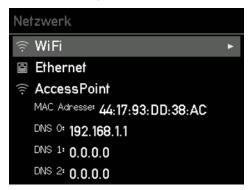
Hinterlege hier die Zugangsdaten für dein WLAN oder konfiguriere dein Ethernet (LAN) um eine Verbindung des Controllers zum Netzwerk und zu go-e Chargern zu gewährleisten. Dies ist für PV-Überschussladen oder dynamisches Lastmanagement unbedingt erforderlich. Außerdem kannst du dich dann über die go-e App auch lokal ohne Cloud mit dem Controller verbinden.
