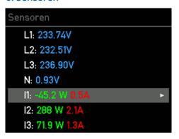
Im Punkt "Sensoren" kannst du die Spannungen, Ströme bzw. Leistungen in Echtzeit ablesen. L1 bis L3 zeigt die Spannung der an der Verbindungsklemme angeschlossenen Phasen. I1 bis I6 zeigt die Werte der angeschlossenen Sensoren (Stromwandler). I entspricht hier der Bezeichnung Internal, was mit dem angeschlossenen Sensor übereinstimmt oder auch Last meint.
