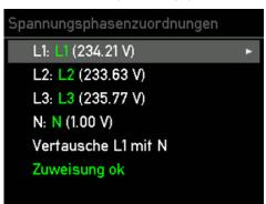
**Optionaler Schritt:** Wähle die Phase, für die du die Zuordnung ändern möchtest, mit der > Taste aus.
