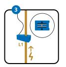
Auch zur Strommessung weiterer 3-phasiger Großverbraucher reicht der Anschluss eines Stromwandlers aus. Du kannst die Stromwandler aber auch verwenden, um den Verbrauch einzelner Stromkreise zu messen, wie z. B. der Beleuchtung, einem Boiler, einer Klimaanlage, der Sauna oder einer Wärmepumpe. Beim Messen dieser Lasten sollte der Pfeil auf dem Stromwandler in Richtung der Last zeigen.
