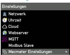
**Für Experten und Integratoren:** Zur Auswahl des Menüpunktes "MEC Meter" die > Taste betätigen.
