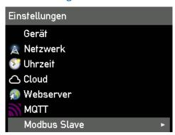
**Für Experten und Integratoren:** Zur Auswahl des Menüpunktes "Modbus Slave" die > Taste betätigen. In dem Untermenü kannst du Modbus aktivieren und entsprechende Einstellungen vornehmen.
