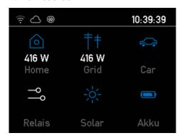
Sobald der go-e Controller betriebsbereit ist, kannst du auf dem Homescreen schon erste Messwerte sehen, die vermutlich noch falsch sind. Die Sensorkonfiguration wird später beschrieben.
