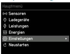
Mit den Auf- und Ab-Tasten am Gerät wechselst du zwischen den einzelnen Menüpunkten.
