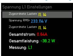
Hier siehst du alle Messwerte der ausgewählten Phase sowie die zugeordneten Lasten (Internals/Staromsensoren). Prüfe einfach, ob die Spannung in etwa stimmt, wenn Strom und Gesamtleistung noch nicht stimmen, ist das kein Problem, denn diese Konfiguration wird etwas später erläutert.
