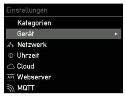
Zur Auswahl des Menüpunktes "Gerät" die > Taste betätigaen. Hier kannst du z. B. die Sprache oder das Display des go-e Controllers an deine Wünsche anpassen.
