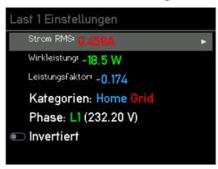
Wählst du auf der Seite "Sensoren" eine der Lasten (I1 bis I6) aus, gelangst du zur Übersicht "Lasteinstellungen".
