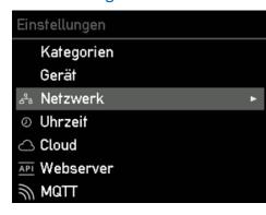
Nun solltest du deinen go-e Controller per WLAN oder LAN in dein Netzwerk bringen. Zur Auswahl des Menüpunktes "Netzwerk" im Untermenü "Einstellungen" die > Taste betätigen.
